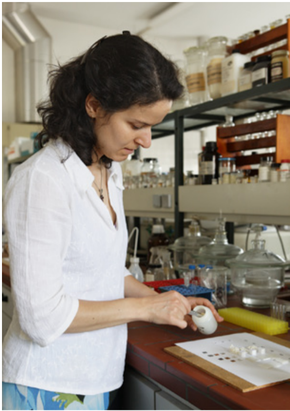
Dr. Marisa Pamplona bei der Vorbereitung eines Oddy-Tests
